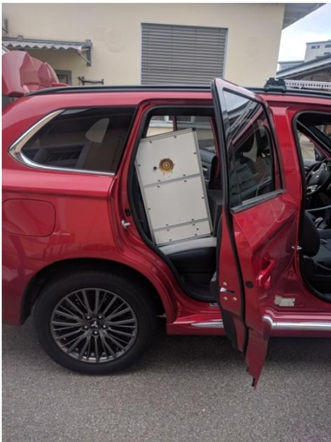
图1，车载Vocus小精灵示意图。一根PFA采样管从图右上角所示的车顶位置，在引流泵的帮助下，将大气样品送至车内Vocus小精灵的进样口处。
